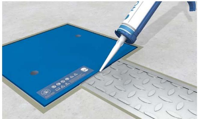
Um zu verhindern, dass Wasser oder Schmutz in die Kasette eindringen, Dichtungsmasse umlaufend um den PCX-Deckel einbringen. So erreichen Sie den Schutzgrad IP65.
