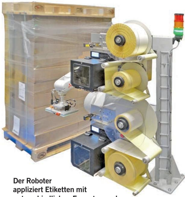
**Der Roboter appliziert Etiketten mit unterschiedlichen Formaten und Klebeeigenschaften auf verschiedenste Oberflächen wie Folien oder Wellpappe.**
