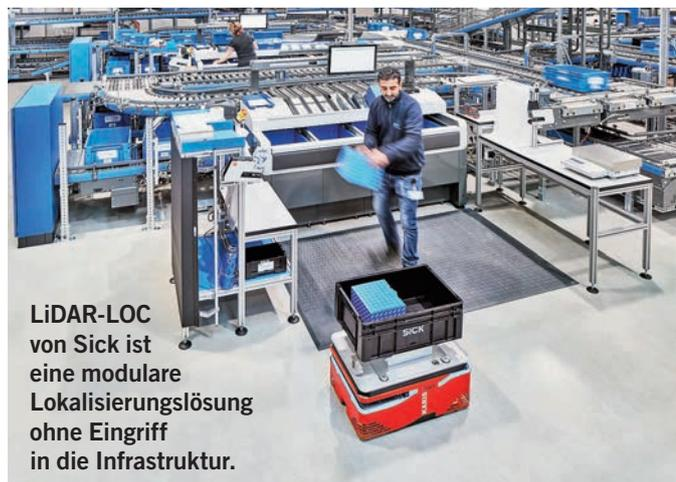
**LiDAR-LOC von Sick ist eine modulare Lokalisierungslösung ohne Eingriff in die Infrastruktur.**
