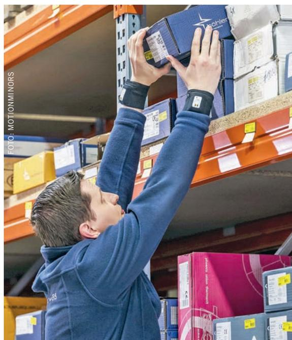
Manschettenscanner am Handgelenk ermöglichen freihändiges Kommissionieren.
