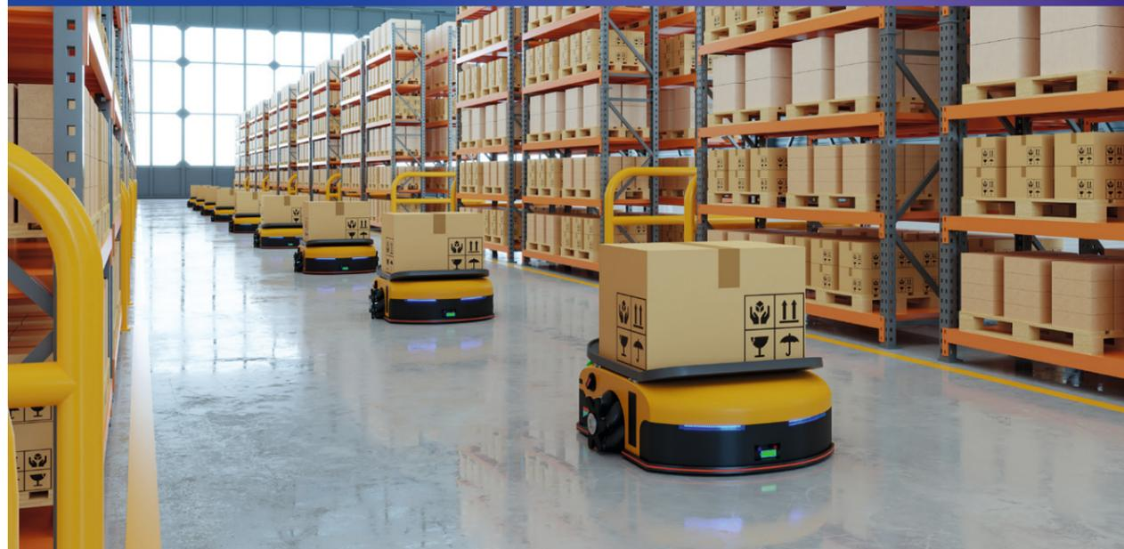
Um dieses Problem zu lösen, wurde die VDA 5050 entwickelt. Sie regelt die Kommunikation zwischen dem Leitsteuersystem und den einzelnen Fahrzeugen. Die Standardisierung der Struktur und der Inhalte der Kommunikation ermöglicht eine reibungslose Integration, Steuerung und Optimierung verschiedener Robotertypen sowie einen reibungslosen Betrieb von hybriden Flotten. Damit lassen sich Flexibilität, Effizienz und Skalierbarkeit erhöhen.
